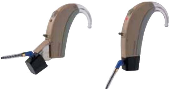
Conecte o cabo de programação ao adaptador, combinando os pontos vermelhos. Os aparelhos devem estar ligados durante a programação. Rode o controle de volume (VC) até a posição 2.
